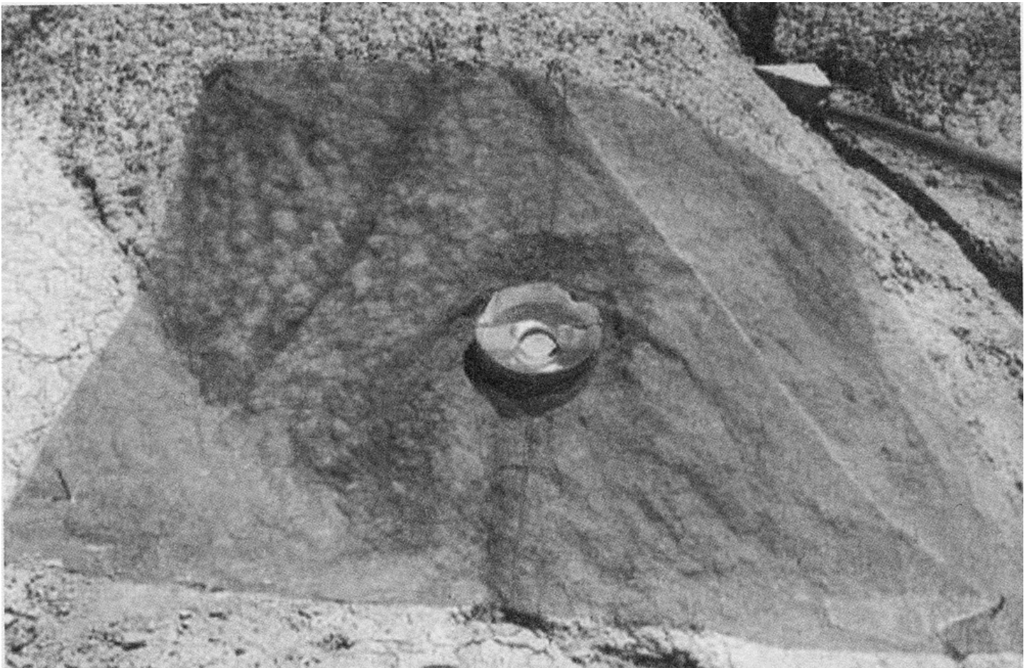
FIGURA 1: Detalle de Taza Morgan con malla alrededor.
