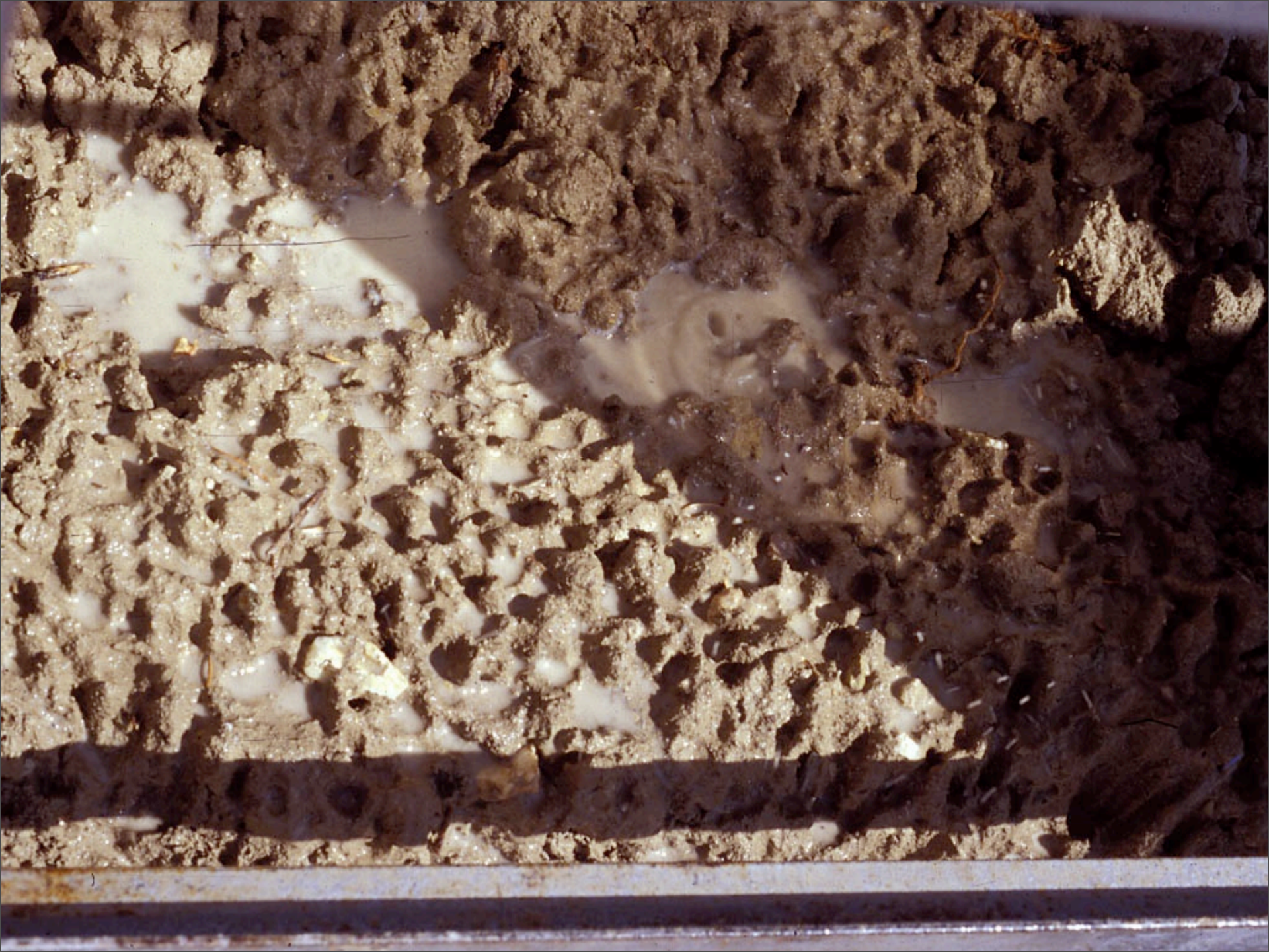
La misma superficie después de la simulación de lluvia.
