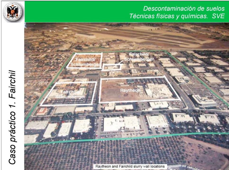
Como primera medida de protección se obligó a cada una de las empresas implicadas a realizar un aislamiento de la zona mediante la construcción de una barrera de protección de las aguas subterráneas (línea blanca de la foto). Se construyó mediante una lechada de bentonita para el sellado de los acuíferos de cada zona.
