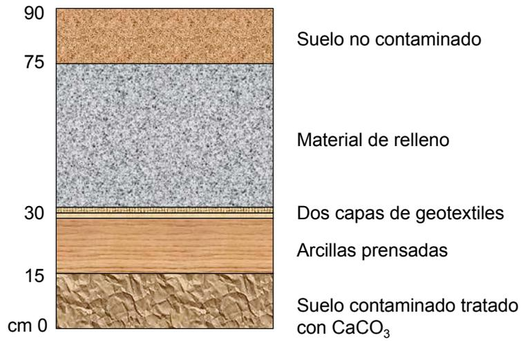
El sellado se realiza mediante una cubierta multicapa que luego se siembra.
